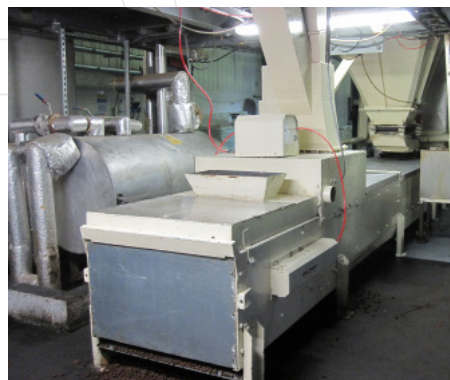
Biomar – Skotland Simatek universalelevator i forbindelse med pakkeri
