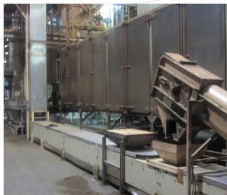
Ewos – Chile Elev.Univ. Simatek conectado con secado de pellets
