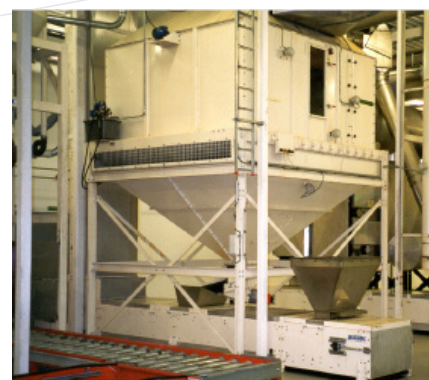
Polar Feed – Norwegen Simatek Pendelbecherwerk in Verbindung mit Kühlung der Pellets
