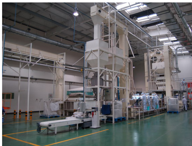
Elevadores Universales Simatek transportando semillas de girasol en China. Foto: Sunshine Produce Ltd., China
