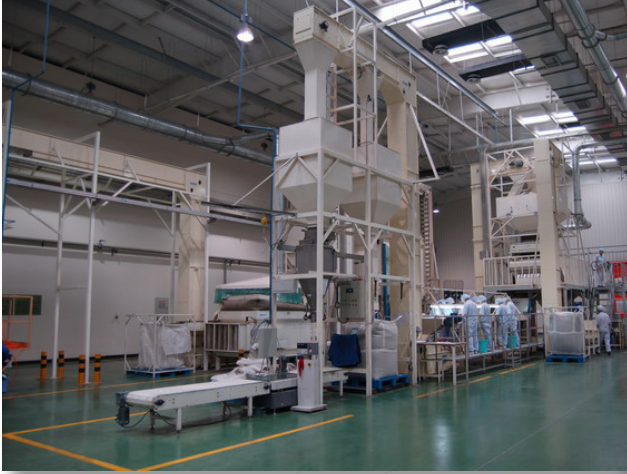
Simatek Universalelevator transporterer solsikkefrø i Kina. Foto: Sunshine Produce Ltd., Kina
