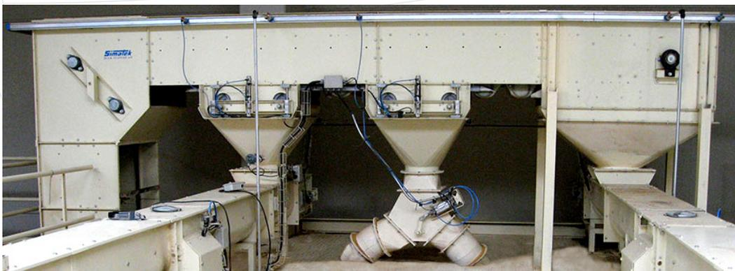
*Pendelbecherwerk Typ 200 mit zwei Zwischenausläufen*
